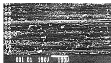
Рис. 12. Поверхность трения образца бронзы Бр010 + 30 % нержавеющей стали X18Н15 с пазами, заполненными фторопластом после двух циклов технологической обработки, x 160
