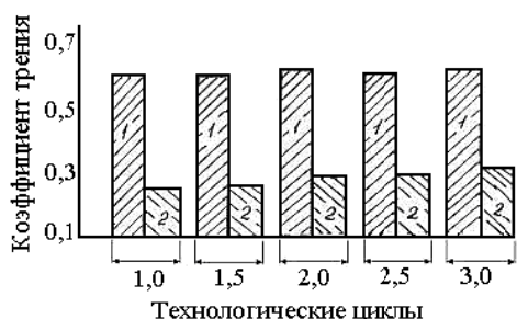
Рис. 7. Влияние количества циклов технологической обработки на коэффициент трения бронзы БрО10: 1 – бронза; 2 – бронза с фторопластом
