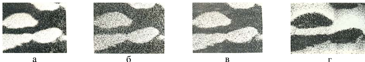
Рис. 14. Изображение поверхности образцов в рентгеновском характеристическом излучении основных элементов, входящих в композицию материала, х 300:
